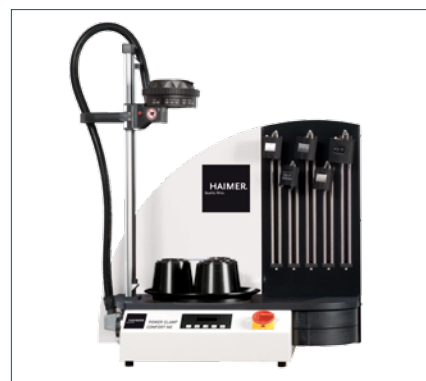
Power Clamp Profi Plus NG nagyteljesítményű zsugorkötő készülék – zsugorítási teljesítmény 20 kW – Ø 3–50 mm átmérőjű szerszámok zsugorításához – HSS és HM szerszámokhoz – nagy tekercs Ø 40–50 mm átmérőhöz (opcionál) – forgótányérral és befogótartóval – szerszámlerakóval – kihajlítható rekeszekkel a tartozékoknak
